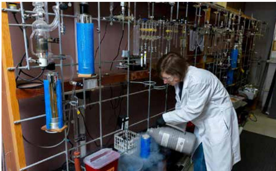
Anna Abramova usa nitrogênio líquido para resfriar amostras de solo do Mojave e medir as taxas de adsorção de CO 2 em diferentes temperaturas.
