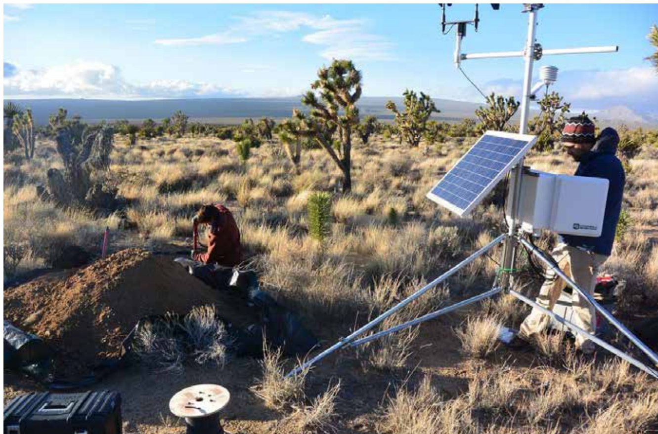
Pesquisadores da UC Berkeley instalam uma estação de sensores no deserto de Mojave, onde o monitoramento contínuo do solo revelou a entrada de CO 2 durante a noite.
